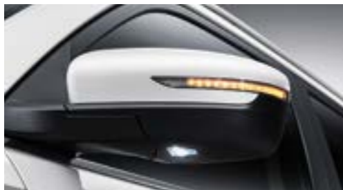
Kierunkowskazy LED i lampki oświetlające podłoże
